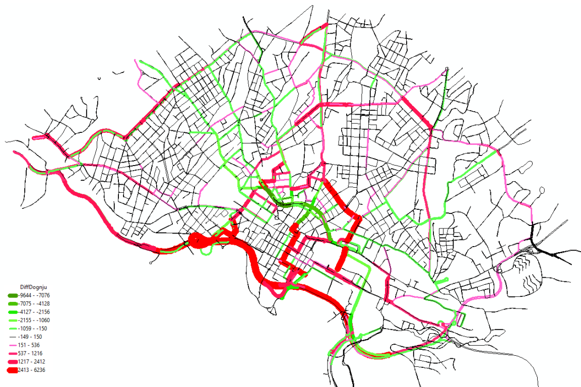
Figur 5 – endring i ÅDT sentrum. Røde streker representerer en økning i ÅDT, mens grønne streker representerer reduksjon. Tykkelsen på strekene og fargeintensitet representerer grad av økning eller reduksjon i ÅDT. Figur 5 finnes i et større format som vedlegg 2.
